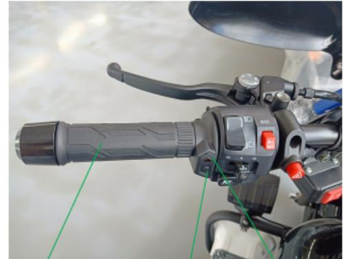
①左加热手把套 ②加热控制开关 ③加热指示灯
