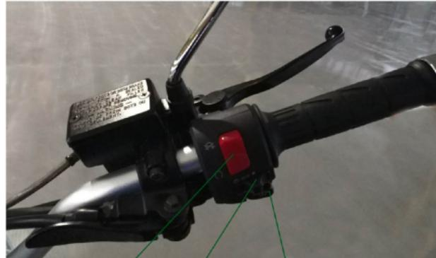
1, COUPE CIRCUIT - 2, INTERRUPTEUR D'ÉCLAIRAGE - 3, DÉMARREUR
